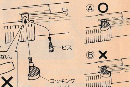
② ビスAをゆるめ、フロント部を引きぬき、コッキングレバーをおさえながら、ビスBをしめ込んで、コッキングレバーを回転させないようにする。
