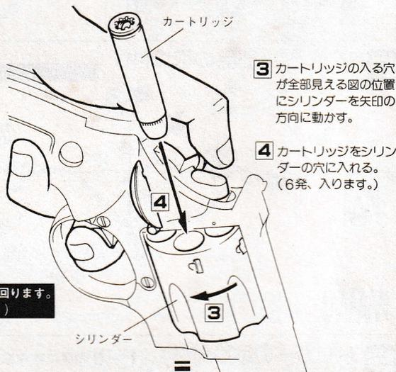
③ カートリッジの入る穴が全部見える箇所にシリンダーを矢印の方向に動かす。
