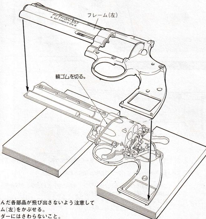
フレームを合わせたら図のように輪ゴムをかける。(2回巻き)
