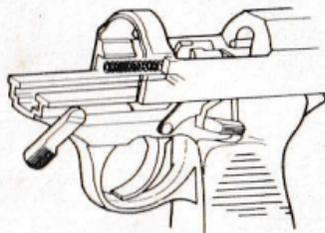
もし、誤ってスプリングがとび出してしまった場合には、図のようにスプリングを両サイドのみぞの穴に差し込んで、ドライバーの先などで、元の位置にもどして下さい。
