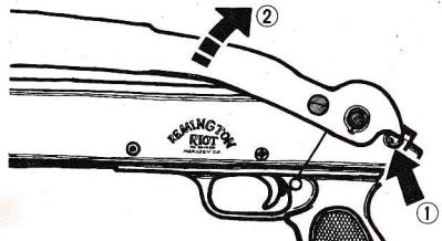
①のボタンを押しながら、ストックを持ち上げロックするまで回します。たたむ時はボタンを押しながら逆の方向に動かします。
