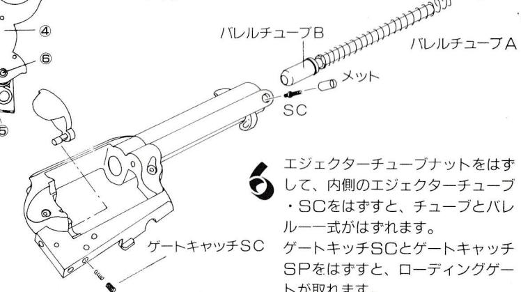
6 エJECTAチューブナットをはずして、内側のエJECTAチューブ・SCをはずすと、チューブとバレル一式がはずれます。
