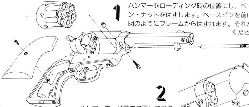
1 ハンマーをローディング時の位置にし、ベースピンSCとベースピン・ナットをはずします。ベースピンを前に抜くと、シリンダーが図のようにフレームからはずれます。それからグリップをはずしてください。
