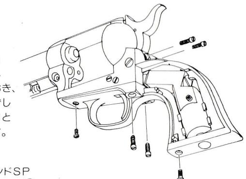
2 ハンマーを一番前まで戻しておき、右図のように日本のビスをはずしてください。トリガー・ガードとバックストラップがはずれます。
