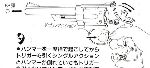
9 ●ハンマーを一度指で起こしてからトリガーを引くシングルアクションとハンマーが倒れていてもトリガーを引くだけでハンマーが動き発射できるダブルアクションの両方が楽しめます。
