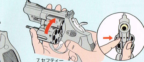
7. セフティー ●シリンダーをスイングインすると自動的にセフティが掛かりトリガーが引けなくなります。 ●解除する時はロッキングボルトピンを裏面より押しかえして下さい。
