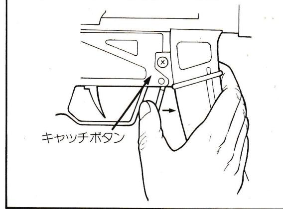
マガジンキャッチを抜く場合は、キャッチボタンでもキャッチレバーでも抜けます。
