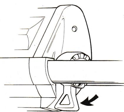
ストックは3段階に調節できます。ストックリリースレバーを矢印の方へ押して自分に合ったポジションに調節して下さい。
