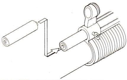
+と-を間違えないようにセットして下さい。間違えて銃にセットしても作動しません。バッテリーキャップの接点は折り曲げないよう注意して下さい。接触不良の原因になります。
