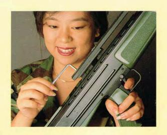
マウントベースが取り付いたらスコープの付いたマウントリングを取り付けます。
