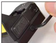
付属のトルクスレンチを使用して、1本のクランプスクリューを締めます。
