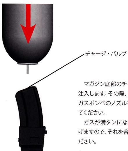
マガジン底部のチャージ・バルブより、ガスを注入します。その際、マガジンは逆さまにして、ガスボンベのノズルを垂直に差し込むようにしてください。
