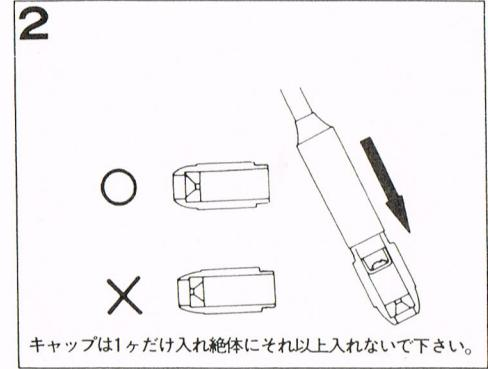
ケースにプラグを入れる（この時プラグを正しく入れて下さい。図参照）キャップを抜きピンの溝の太い方で押し込んで下さい。この時細い溝の方では絶対に押さないで下さい。危険です！
