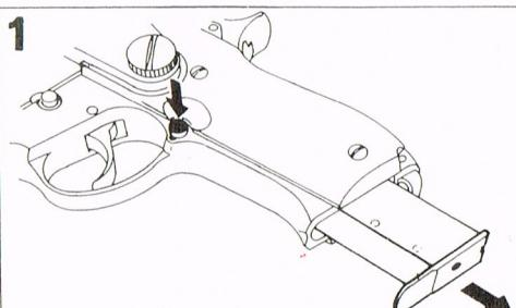
マガジンキャッチナットを押してマガジンを抜いて下さい。
