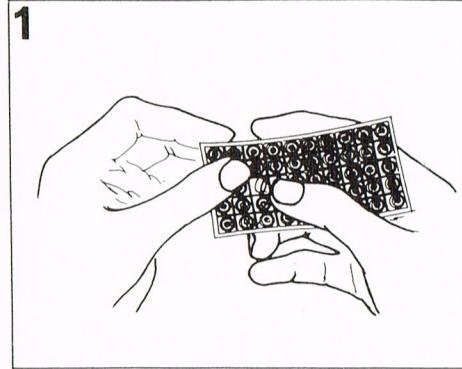
プラグ・ファイヤーキャップはランナーから一つづつていねいに取って下さい。乱暴に抜うと暴発したり火薬がキャップから取れてしまいます。箱の説明をよく読んで正しく使用して下さい。
