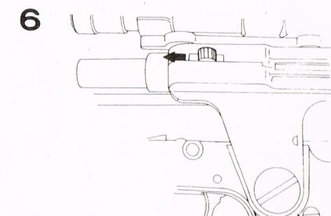
カットオフレバーを図の矢印の方向へ動かします。
