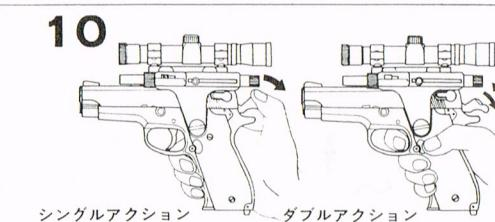
ハンマーを一度指で起こしてからトリガーを引くシンブルアクションとハンマーが落ちてもトリガーを引くだけでハンマーが動き発火するダブルアクションの両方が楽しめます。もしハンマーが落ちても発火しない場合はシングル・ダブルアクションの動作を繰り返す事により発火させることができます。
