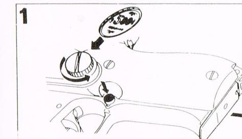
マガジンを抜きティクダウンスクリューを回してはずして下さい。もし回しにくい時は、コインを使って回して下さい。
