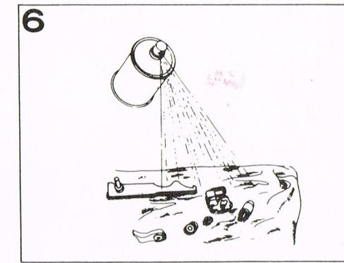
P·F·Cや銃の金属部品などは組み立てる前にスプレー式のオイルを軽くかけておいて下さい。ただしプラスチックにはシリコン系のオイル又はグリースを可動部分に塗って下さい。
