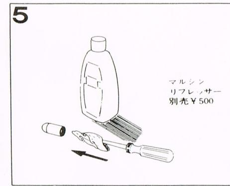
汚れが落ちない場合は当社のリフレッサーを使用しますときれいにクリーニング出します。発火後なるべく早くクリーニングした方が簡単に落ちます。
