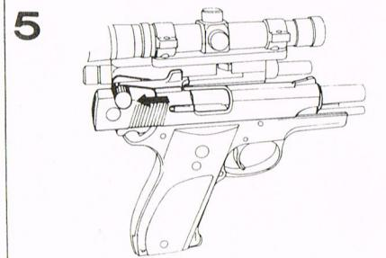
コッキングノブを引いてスライドを一杯にさげ、手を放して下さい。手を放すとスライドが前進し第一弾目のカートリッジがバレルに送弾されます。
