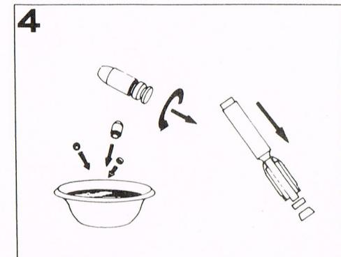
発火後のクリーニングはリムを上図の方向に回してケースからはずし抜きピンを使用してキャップとプラグを抜いて下さい。P·F·Cとバレル、ファイヤリングピンのクリーニングは水で洗って布でふき取れば充分です。
