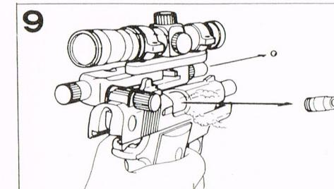
トリガーを引くとプローバックしカートリッジが自動的に飛び出し、BB弾が発射されます。トリガーを引くだけでこの動きが8回連続して繰り返えされます。
