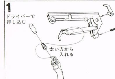
(完全に分解した場合) サブフレームにディスクネクター、ドローバーシア、シアーリースレバーを図の様に組み込みます。
