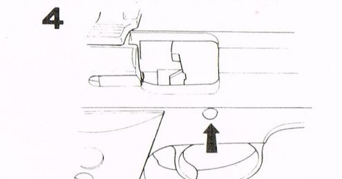
ティクダウンピンを反対側から押して抜き取ります。
