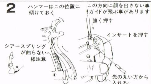
インサートを入れる時まず上方を先に入れます。この時ハンマーはハーフコックの位置にすれば楽に入ります。次にドライバーでメインスプリングガイドを押しながらインサートを完全にはめ込みます。
