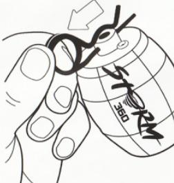
グレネード本体をしっかりと持ち、本体天面の注入バルブからガスを注入します。注入バルブに対して最大限の動作をさせる為、装填口にBB弾が見えるようにノズルが垂直になるようにしてガスを注入してください。ガスの「吹き返し」が起きると満充填のサインです。
