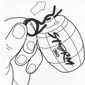
ファイアリングボタンの突起の側面からセティピンを挿し込みます。挿入後にセティピンを横向へ倒すとファイアリングボタンの突起の外周にそうようにセティピンが固定されます
