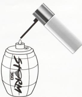
ファイアリングボタンを押し下げた後、グレネード天面の穴から潤滑性の高いシリコンオイルを少量注入します
